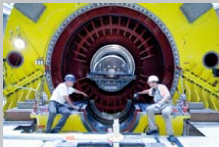
Reparaturen an Generator und Turbine im Rahmen einer Revision
