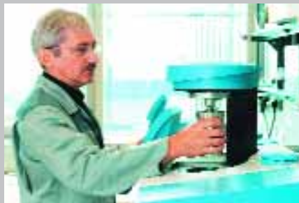
Rudolf Wieland, stellvertretender Leiter des Zentrallabors, am Kalorimeter zur Bestimmung des Energiegehalts von Brennstoffen
