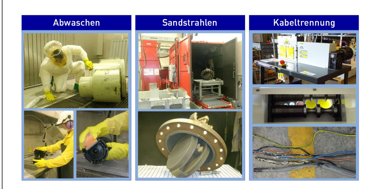
Abbildung 7: Beispiele für Verfahren zur Behandlung von Reststoffen
