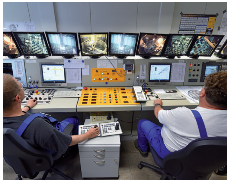
Der Reaktordruckbehälter wurde unter Wasser fernhantiert zerlegt und verpackt.
