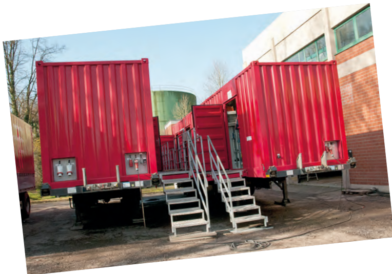
Die modernen Entwässerungsanlagen der MSE kommen per LKW an die Kläranlage.
