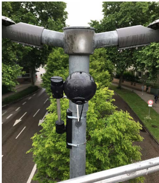
Die Kamera von Smight Traffic erfasst den Verkehrsfluss in Echtzeit.
