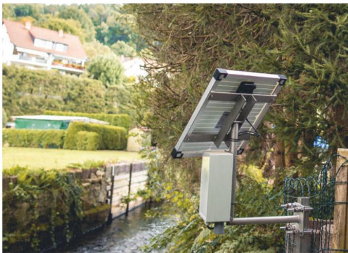
Das intelligente EnBW-System NOYSEE misst Pegelstände und alarmiert im Notfall die Rettungskräfte über Mobilfunk.
