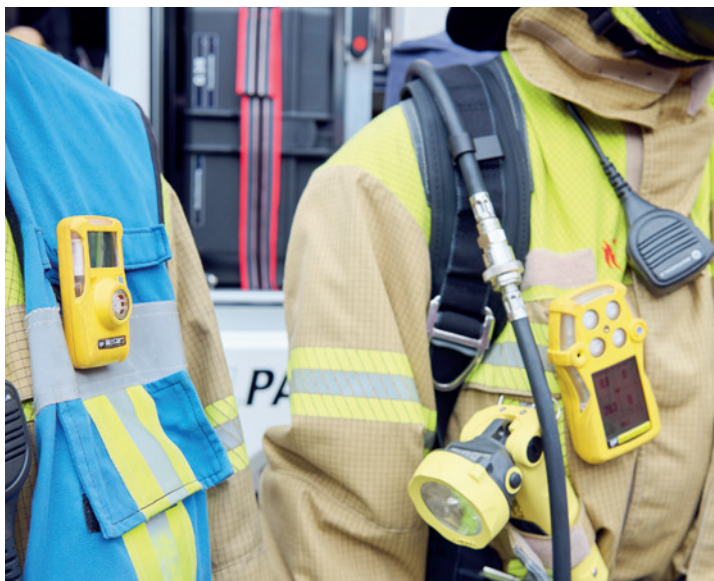
Das Risiko stets im Blick: Schwieberdingens Feuerwehrkommandant Jürgen Jonetzko (r.) am Steuer eines Fahrzeugs. Seine Kamerad*innen haben ihre Schutzausrüstung angelegt. Dazu gehören auch Gaswarngeräte. Die kleinen gelben Instrumente werden mit einem Clip an der Kleidung befestigt. Die einfache Version verfügt über einen Sensor, der nur Kohlenstoffmonoxid misst, die größere Ausführung kann drei weitere Gase wahrnehmen.
