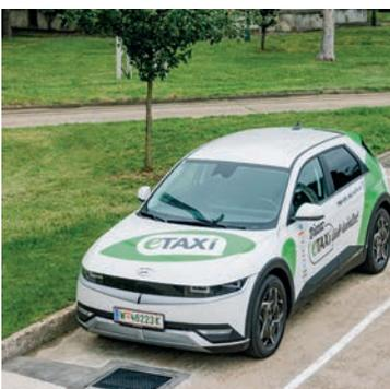
Dank der automatisierten konduktiven Technik kann jede Minute am Standplatz für das elektrische Laden genutzt werden.
