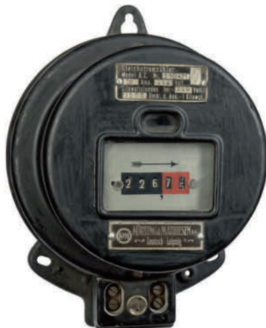
Aus den Anfängen des 20. Jahrhunderts: ein Gleichstromzähler
