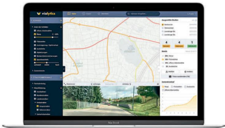
Die Online-Karte ermöglicht es, Straßenschäden schnell aufzufinden und Ausbesserungsmaßnahmen genauer zu planen.
