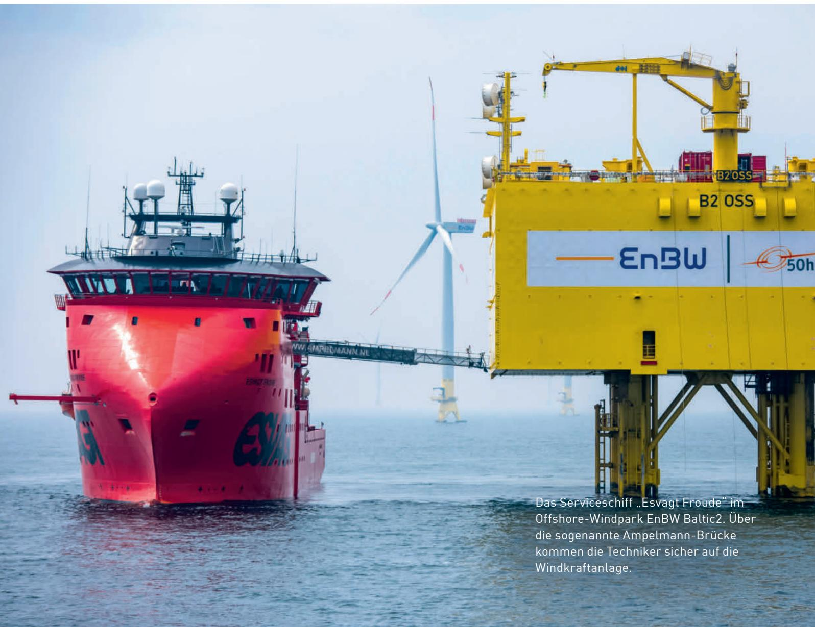
Das Serviceschiff „Esvagt Froude“ im Offshore-Windpark EnBW Baltic2. Über die sogenannte Ampelmann-Brücke kommen die Techniker sicher auf die Windkraftanlage.
