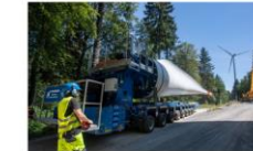
01 Die Anlagenteile werden mit Tiefladern in Übergröße transportiert. Dazu ist bei einzelnen Kurven ein Ausbau notwendig.
