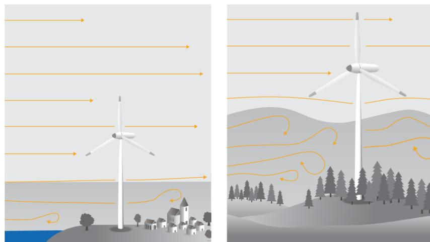
Strömungsverhalten ■ gleichmäßig, geeignet und ■ turbulent, ungeeignet – weit oben ist der Wind am stärksten
