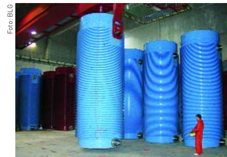
Handhabung eines Castorbehälters
