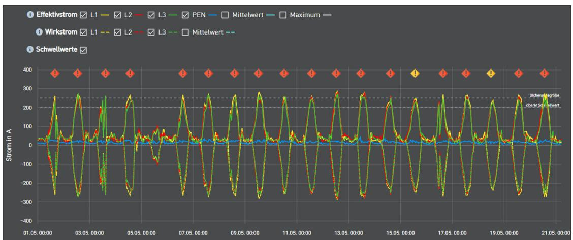
Beispiel: PV-Anlagen sorgen täglich für eine Verletzung des Sicherungswertes.
