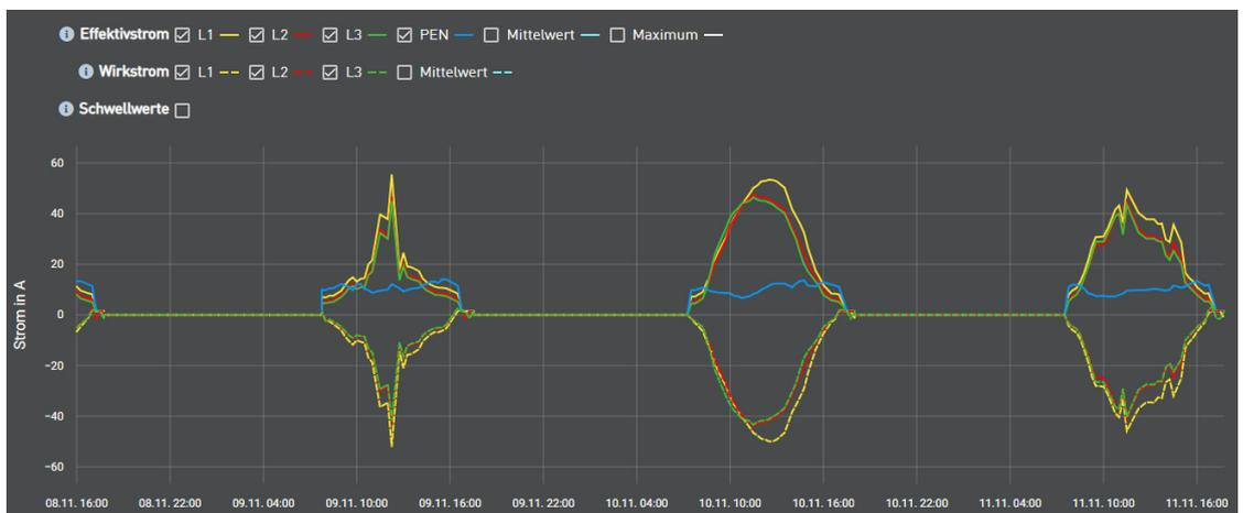
Beispiel: Eine PV-Anlage führt mit 77 kWp zu einer hohen PEN-Belastung.
